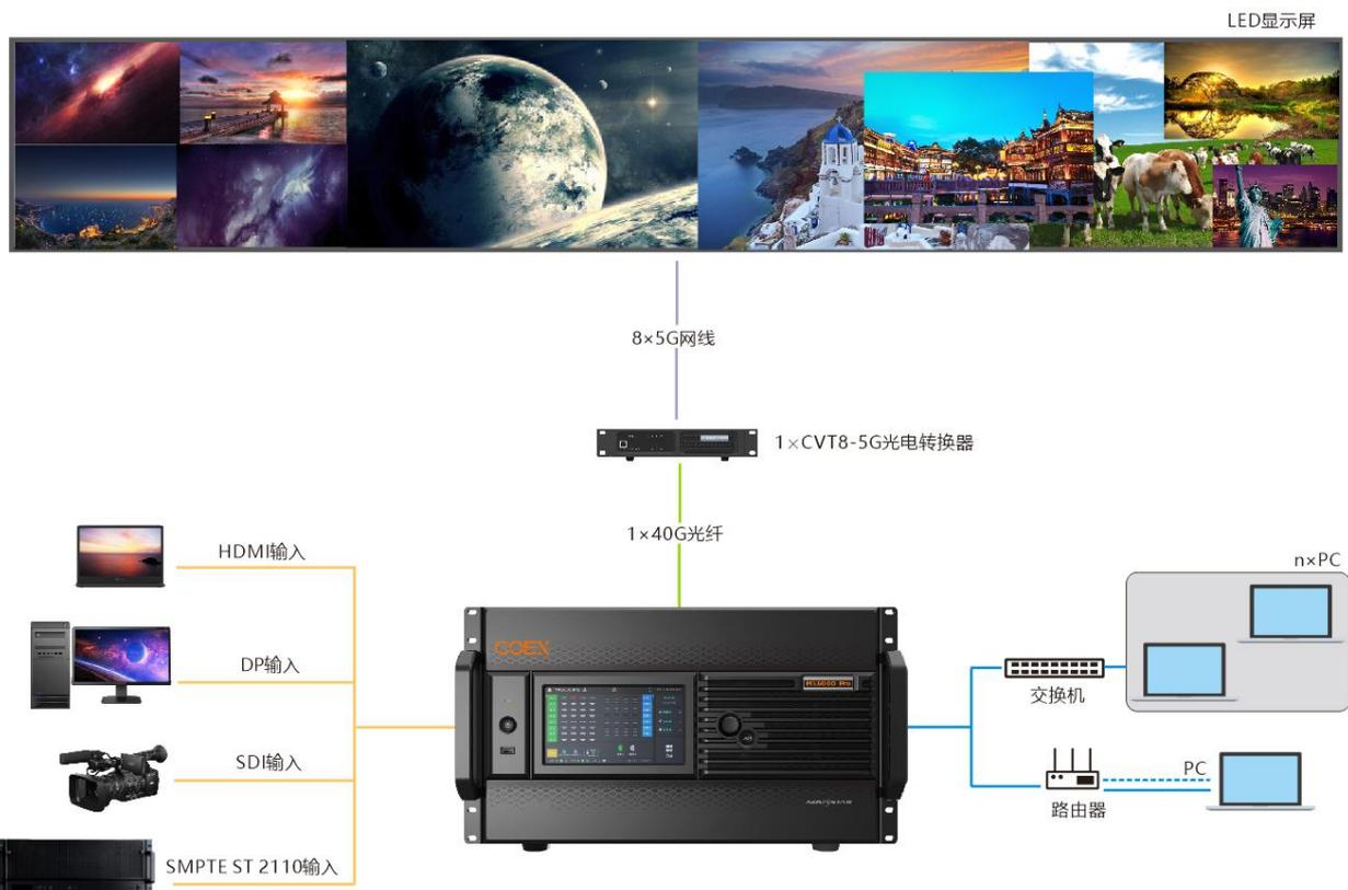
此图为安装 4 张输入子卡、1 张 1×40G 光口输出子卡的示意场景，仅供参考，请以现场实际使用情况为准。
