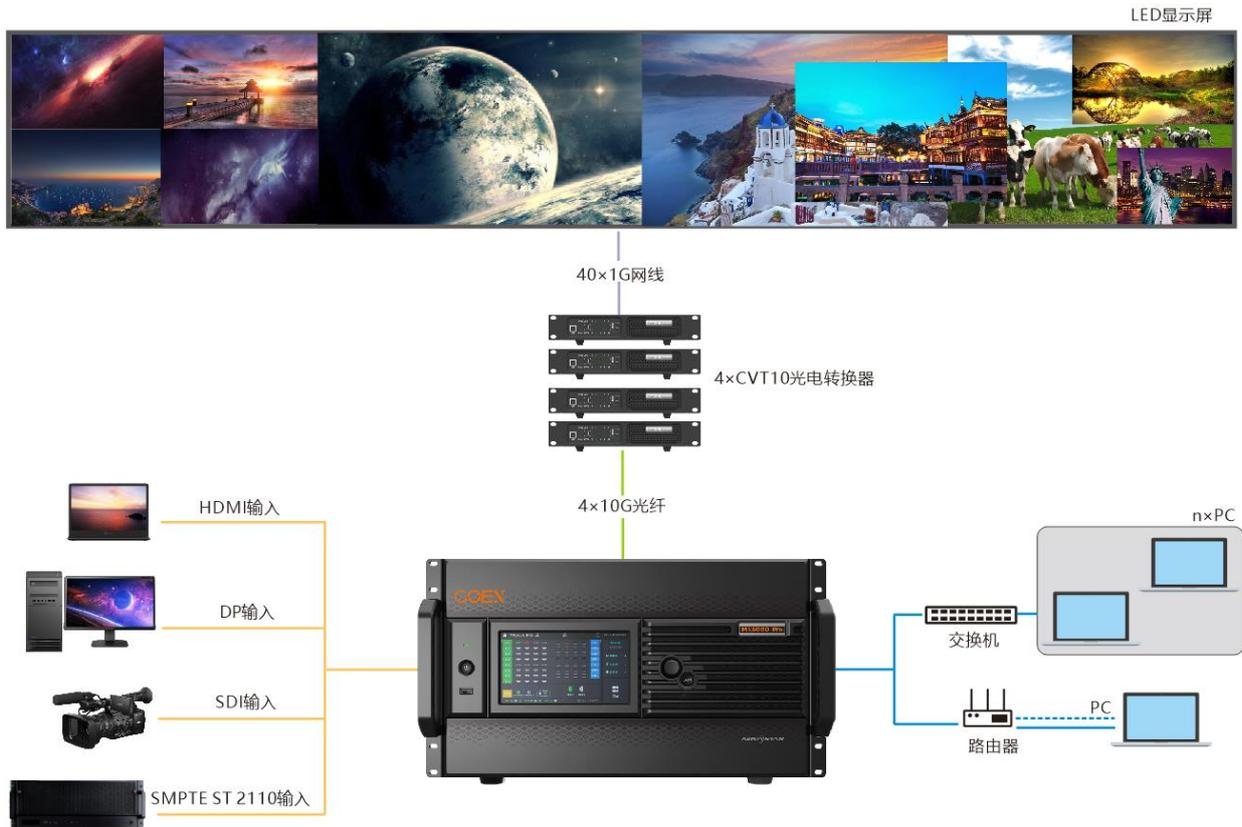
此图为安装 4 张输入子卡、1 张 4×10G 光口输出子卡的示意场景，仅供参考，请以现场实际使用情况为准。
