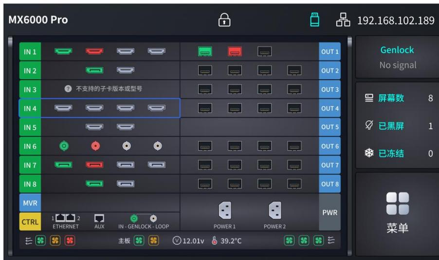
图4-2 输入卡和输出卡详情
