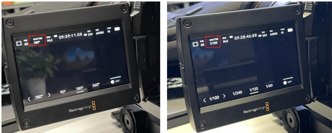
图2-14 相机快门角度/速度示例（由于摄像机型号不同参数位置可能不同，仅供参考）
