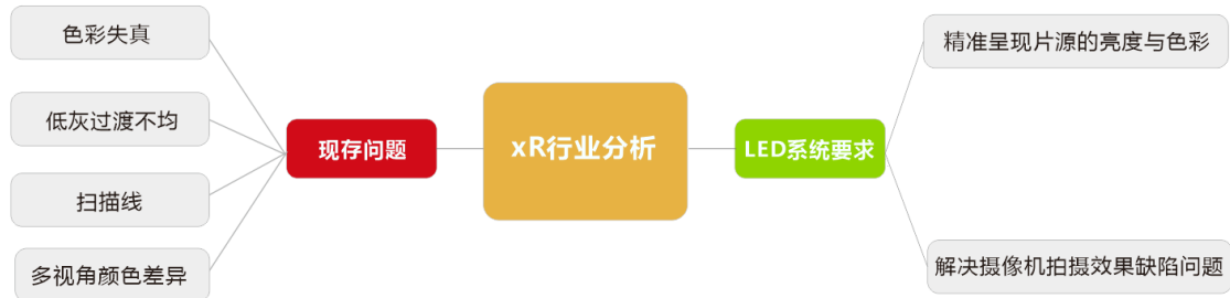
图1-2 xR 应用现存问题及对 LED 系统的要求
