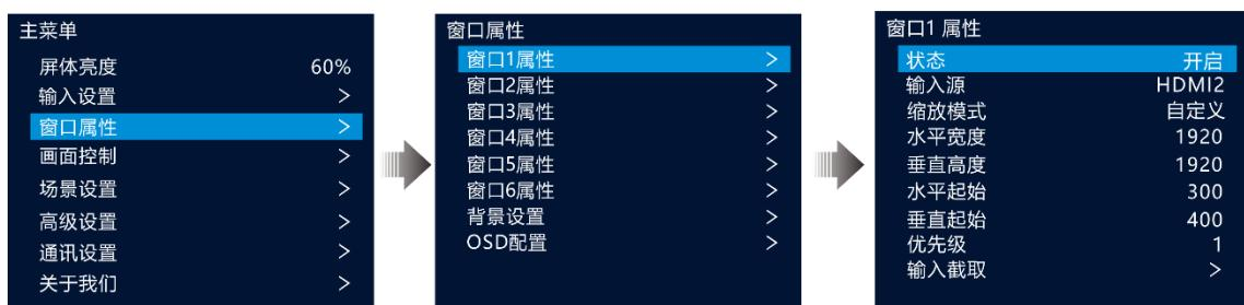
步骤 4 旋转旋钮选择“状态”，按下旋钮并旋转旋钮选择“开启”，再次按下旋钮，将窗口“状态”设置为“开启”。
