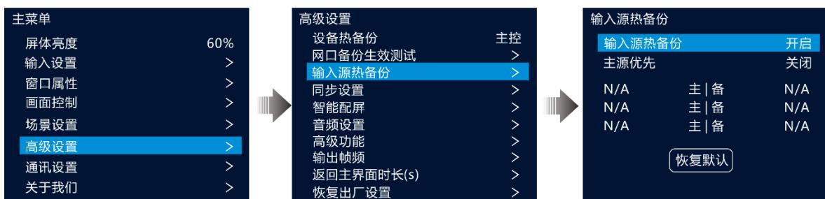
步骤 2 旋转旋钮选择“输入源热备份”，旋转旋钮选择“开启”，再次按下旋钮开启输入源热备份。
