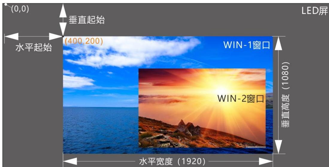
步骤 7 旋转旋钮选择“优先级”，设置窗口优先级，优先级用数字表示，数字越大，优先级越高，窗口越靠前显示。
