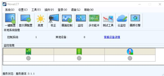
步骤 2 选择“工具 > 控制器箱体配置文件导入”，进入“控制器箱体配置文件导入”界面。
