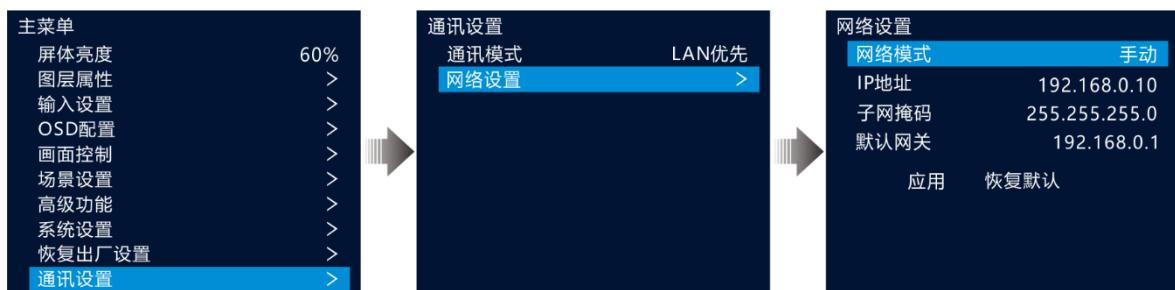
步骤 3 旋转旋钮选择“网络模式”，设置网络模式。
