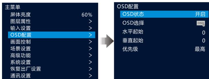
步骤 3 旋转旋钮选择“OSD 状态”，按下旋钮并旋转旋钮选择“开启”，再次按下旋钮，将图层“OSD 状态”设置为“开启”。
