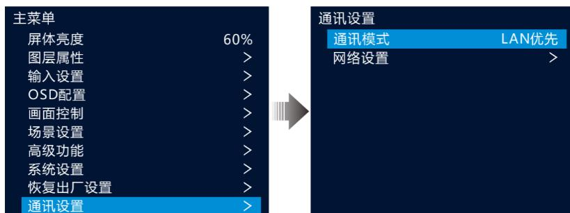
步骤 2 旋转旋钮选择“通讯模式”，按下旋钮启用通讯模式设置，旋转旋钮选择通讯模式，并按下旋钮确认。
