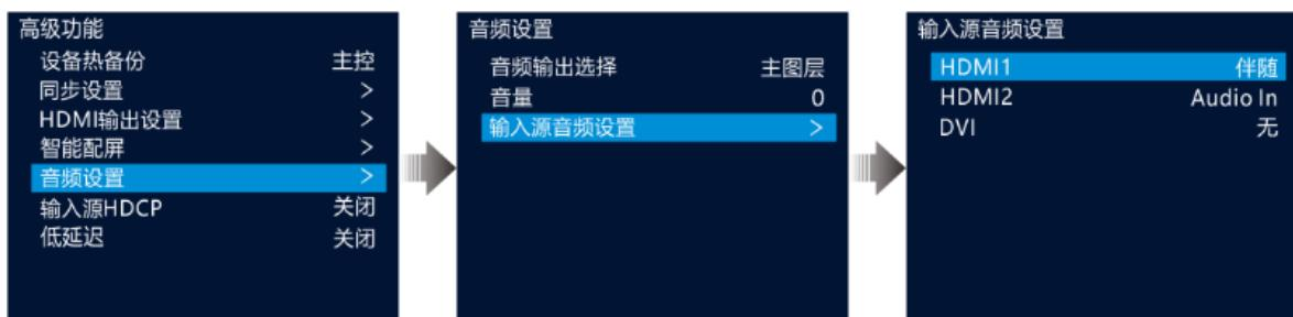
步骤 3 旋转旋钮选择输入源，按下旋钮启用输入源音频设置。
