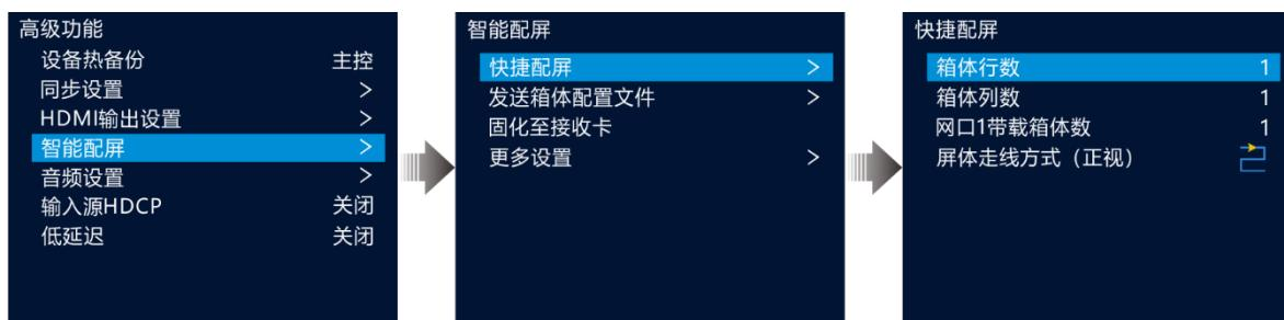
步骤 3 旋转旋钮至“网口 1 带载箱体数”，设置网口 1 带载的箱体数量。
