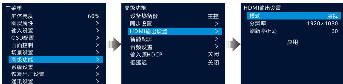
步骤 2 旋转旋钮选择“模式”，设置 HDMI 接口输出模式。
