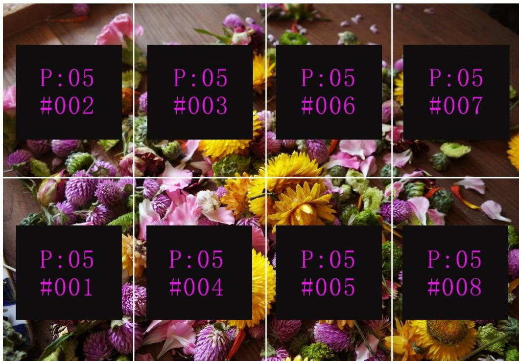
P:05 表示发送设备的网口编号，#001 表示该网口带载的箱体编号。
