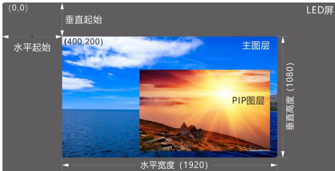
步骤 7 旋转旋钮选择“优先级”，设置图层优先级，优先级用数字表示，数字越大，优先级越高，图层越靠前显示。
