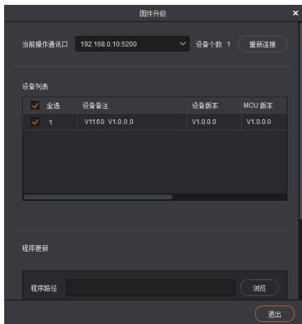
步骤4 单击“程序更新”后的“浏览”，在打开的对话框中选择固件程序包（\*.img）。
