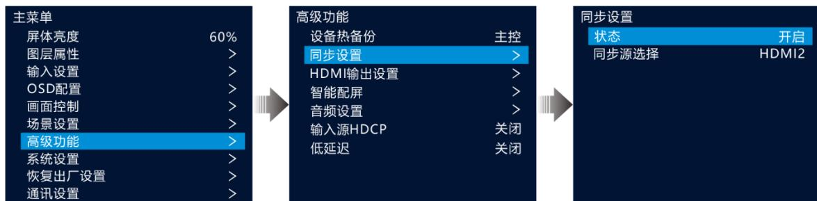
步骤 2 旋转选择“状态”，按下旋钮并旋转旋钮选择“开启”，按下旋钮将同步状态设置为“开启”。
