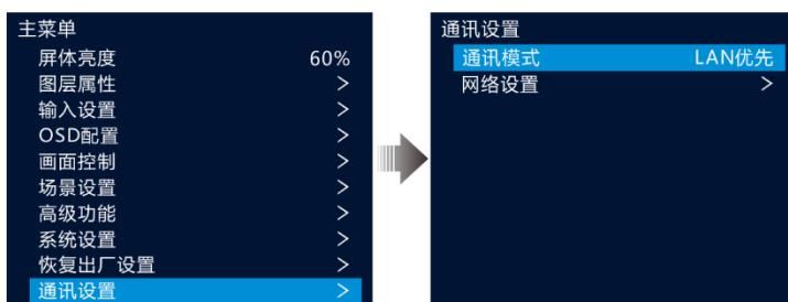
步骤 2 旋转旋钮选择“通讯模式”，按下旋钮启用通讯模式设置，旋转旋钮选择通讯模式，并按下旋钮确认。
