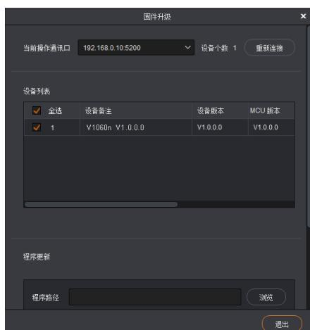
步骤 4 单击“程序更新”后的“浏览”，在打开的对话框中选择固件程序包所在路径。
