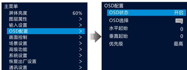
步骤3 旋转旋钮选择“OSD状态”，按下旋钮并旋转旋钮选择“开启”，再次按下旋钮，将图层“OSD状态”设置为“开启”。
