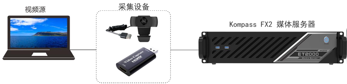
图5-15 采集卡输入连接方式
