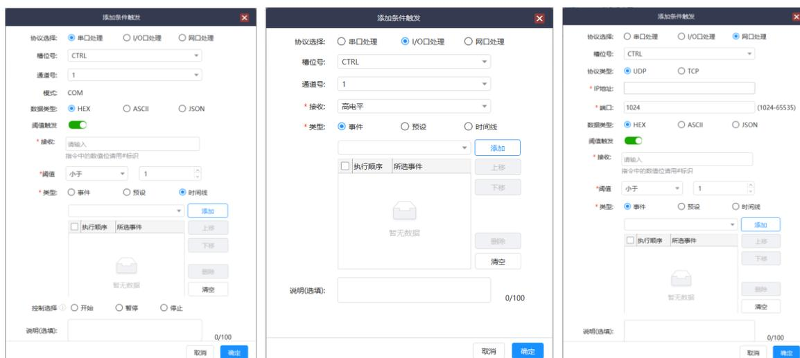
步骤 3 选择条件触发协议，支持“串口处理”、“I/O 处理”或“网口处理”三种处理协议。
