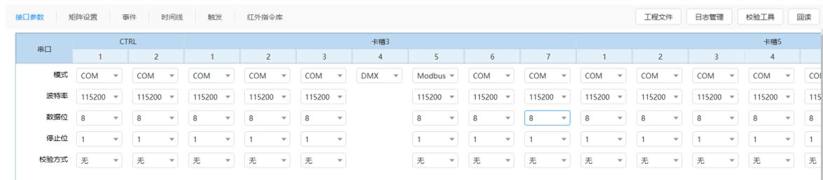
COM 模式和 Modbus 模式对接参数相同，需要配置“波特率”、“数据位”、“停止位”和“检验方式”，这些参数需要与受控设备的参数保持一致。
