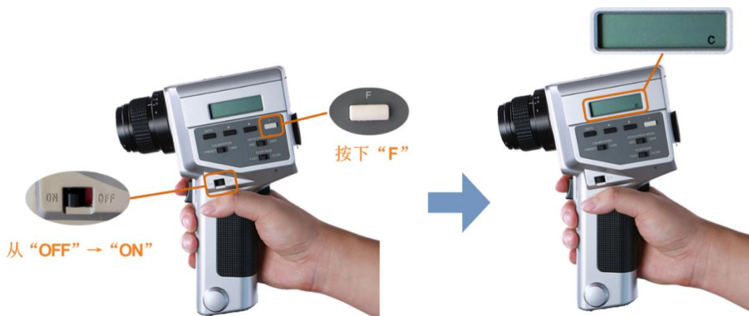
图12-10 设置 CS-100A 色度计
