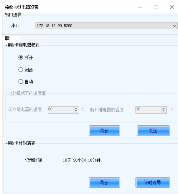
图8-4 设置接收卡继电器
