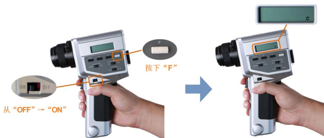
图12-7 设置 CS-100A 色度计
