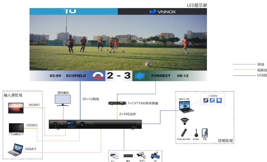
步骤 4 将 LED 显示屏的引出网线按下图所示顺序接入 TU40 Pro LED 播控处理器的输出网口。
